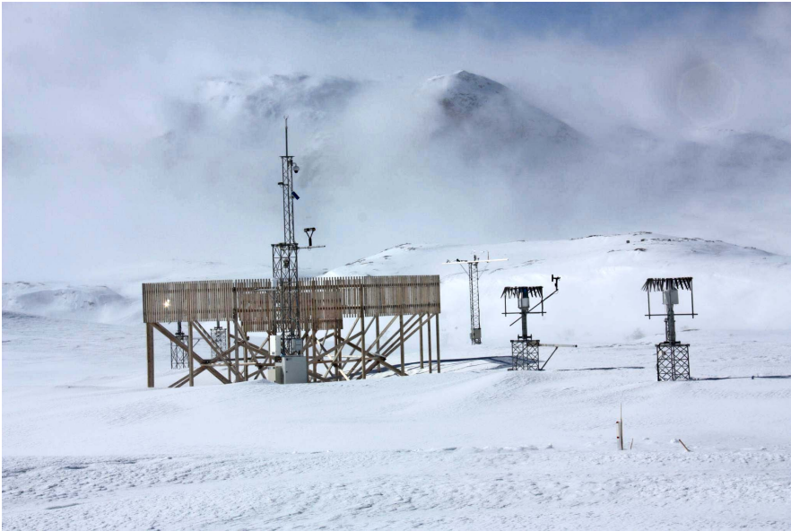
Figur 3.5 Omfattende instrumentering og målinger på Haukeliseter testfelt har gitt ny innsikt i oppfangingsvikt av vinternedbør. Dette har gitt oss økt kunnskap om egenskaper og kvalitet til kjente og nye sensorer, samt bedre forståelse av andre kjente feilkilder ved nedbørmålinger. Foto: Roy Rasmussen
